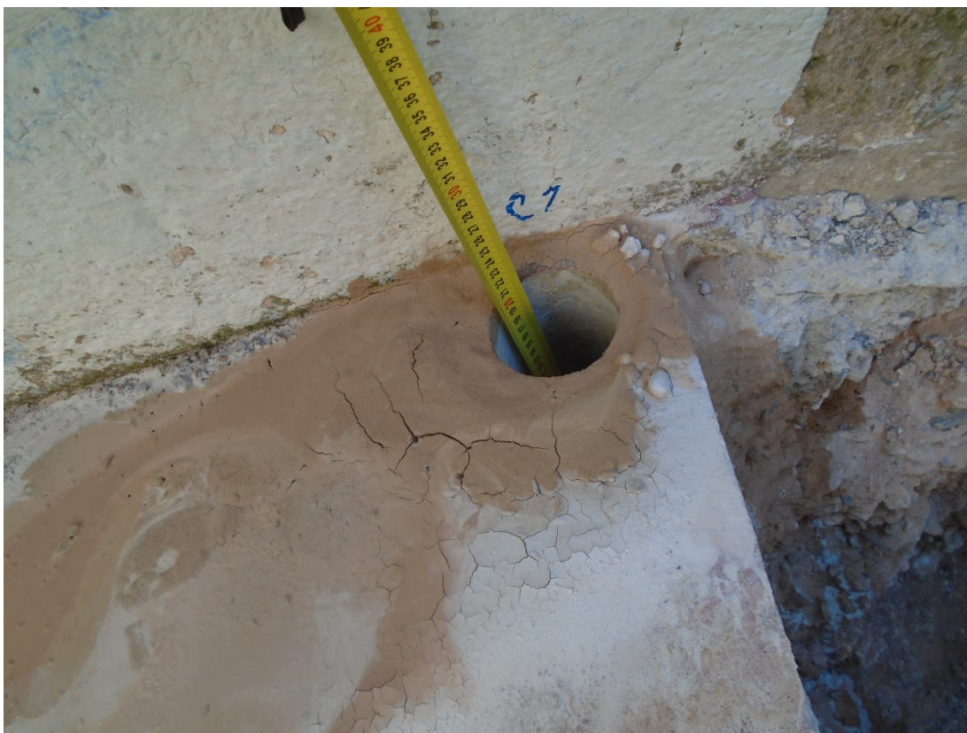
Foto 9: Testigo de cimentación C-2. Tensión de rotura en compresión 12,85 N/mm 2 .
